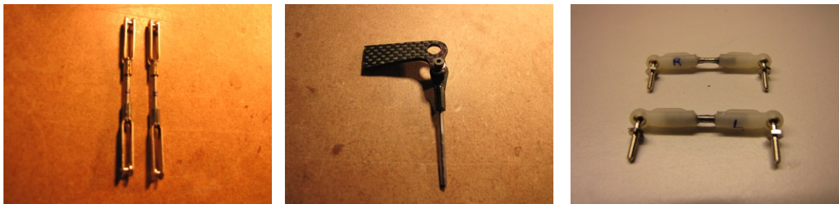
Verschiedene Ausführungen von Anlenkstangen für Wölbklappen. Höhenruder und Bremsklappen.
