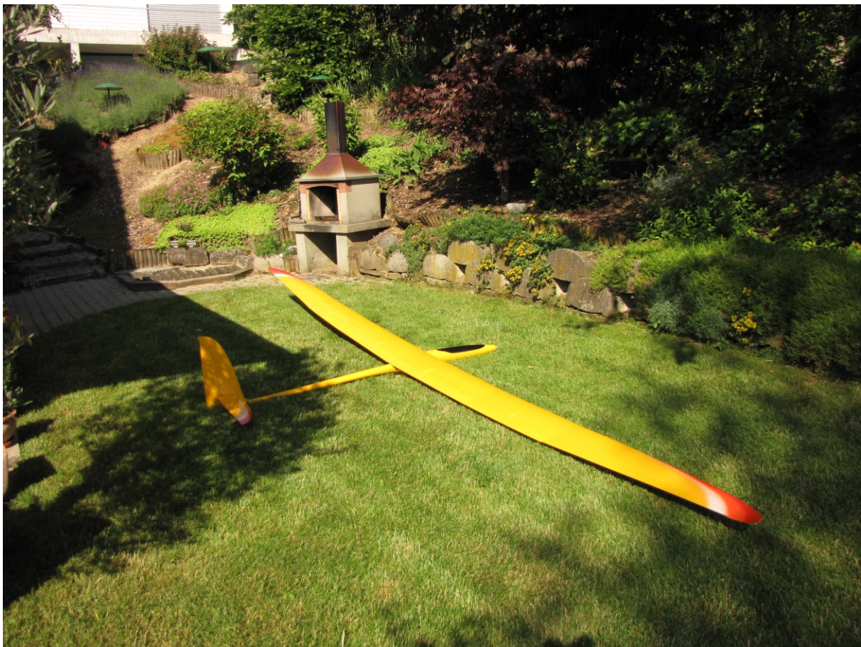
Thermik XXXL von Valenta in motorisierter Ausführung. 8-Klappen-Fläche in CFK mit Spannweite 4.94m
