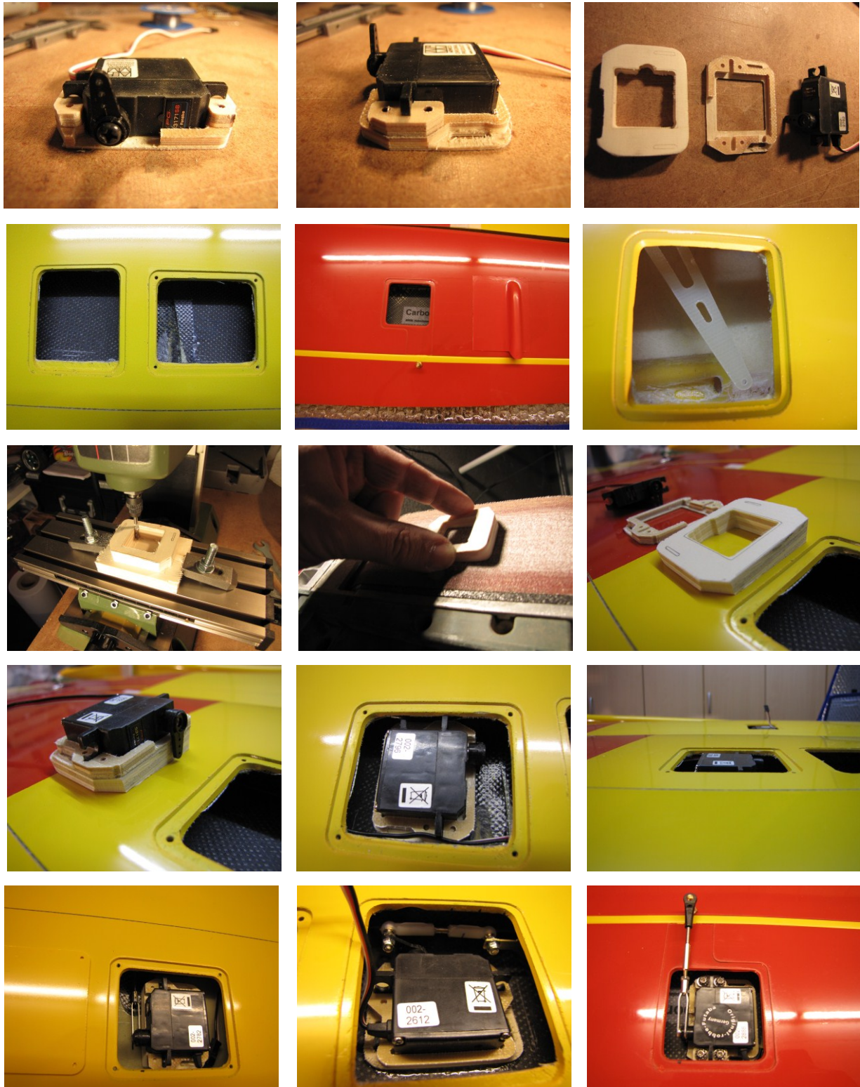
Die werkseitigen Servorahmen passen perfekt für die gewählten Servos. Blick in den Servoschacht für Bremsklappe und Wölbklappe, sowie Querruder und Heck. Aufdoppelung des Servorahmens bei den inneren Querrudern und den Wölbklappen. Flächenbündiger Servoeinbau für maximale Platznutzung. Nahezu spielfreie Anlenkung für innere Querruder, Bremsklappen und äussere Querruder.
