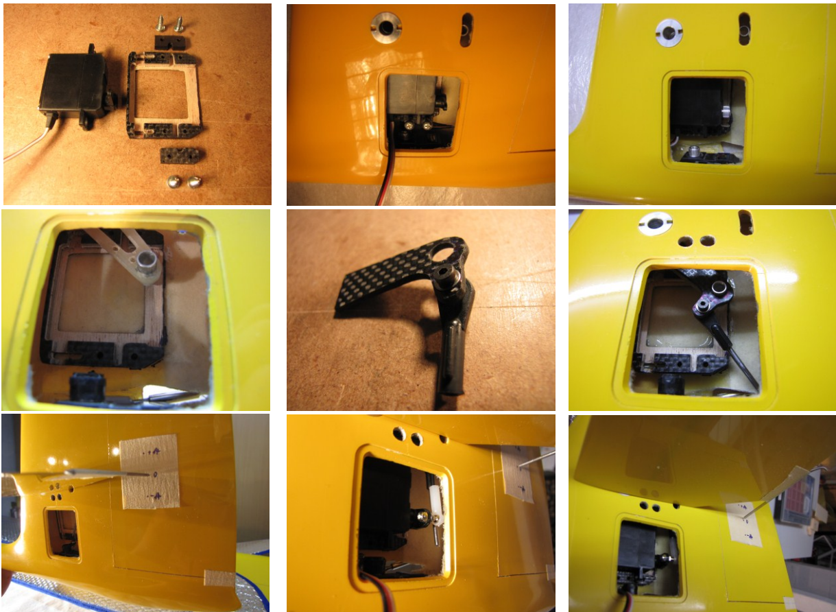
Massgenaue Endfertigung an der Höhenleitwerksanlenkung
