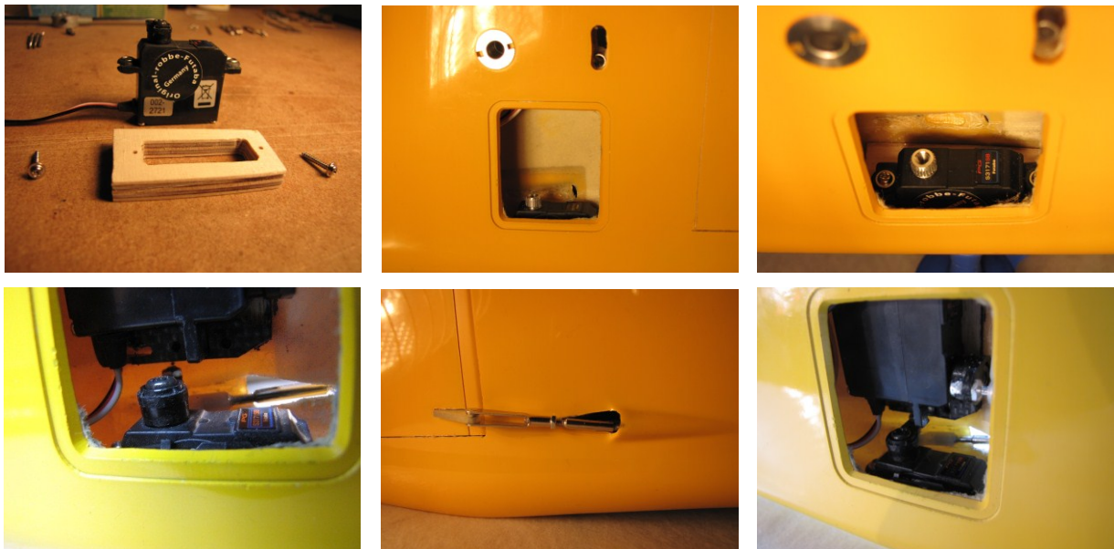
Einbau des Seitenleitwerksservos mittels Spant. Anlenkung mit Kugelkopf und Gabel.
