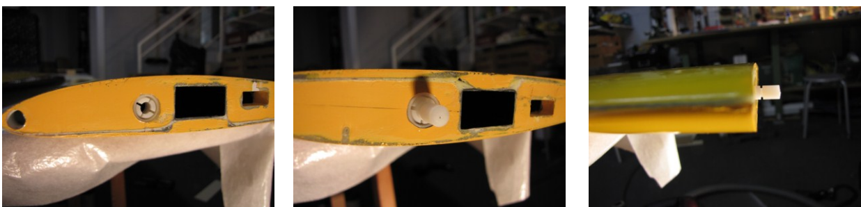
Das Multilock wurde auf Grund der strengen Steckung bei den Aussenflächen weggelassen. Der Zapfen dient als Einbauhilfe
